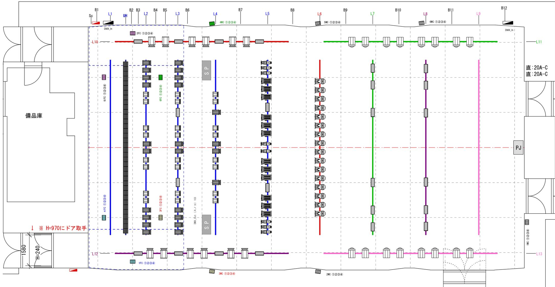
バトン長さ : L9, 000mm 許容荷重 : 美術バトン=450kg、ライトバトン=250kg
